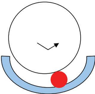
Dieses Verfahren rollt je Umdrehung der großen Rolle so viele Gewinde auf, wie Segmente vorhanden sind. Der Innenumfang des Segments muss dem Umfang des Bolzens entsprechen. Anwendung findet dieses Verfahren bei hohen Anforderungen an die Genauigkeit des Gewindes. Das Werkstück erhält sein Gewinde durch Druck zwischen Segment und Rolle.
