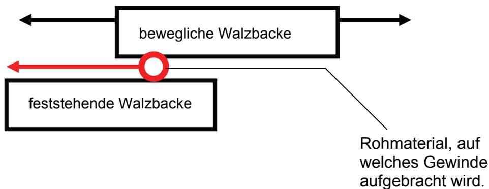
Abbildung 8: Prinzip Gewindewalzmaschine
