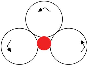
Auch Rollkopfverfahren genannt. Hier werden die drei Rollen in einem „Rollkopf“ geführt. Anwendung findet dieses Verfahren im CNC-Bereich. Das Werkstück erhält das Gewinde durch den Druck von drei Rollen.
