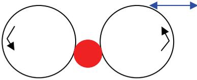
Die beiden Rollen laufen in gleicher Richtung. Das Gewinde wird durch Druck der seitlichen Rollen auf das Werkstück eingedrückt.
